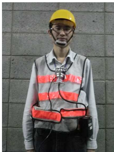
圖 2.5 個人奈米採樣器實際配戴圖。
