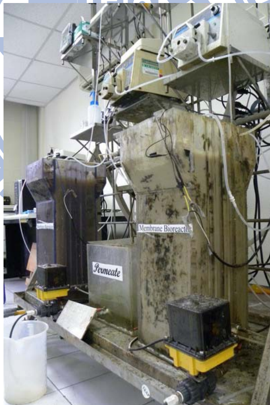
圖 3-2 MBR 系統之實際操作情況
