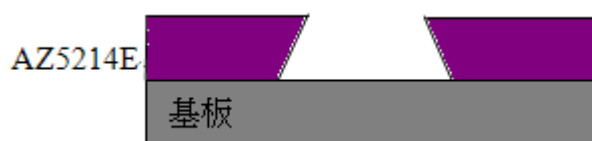
圖 3-4 光微影製程流程示意圖。分為旋轉塗佈、曝光、反轉烤、全曝、顯影幾個步驟。
