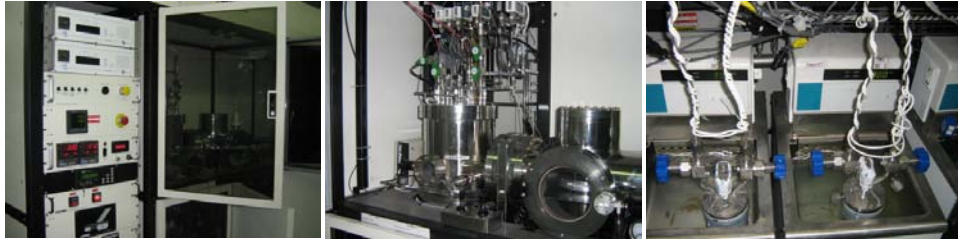
圖 2-1-2 EMCORE D-180 MOCVD 的溫控系統、反應腔、bubbler
