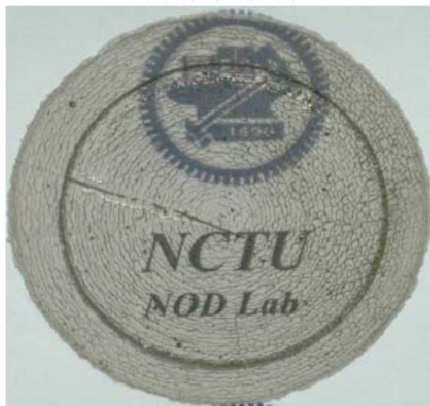
圖 1-2-1 本實驗室所生長之 1.2 吋氮化鎵基板(中心厚度 480 \mu m)[11]
