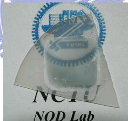
圖 4-1-4-3 經氫氣在 100 torr 下蝕刻 30 分鐘後的氮化鎵表面 (方框內為氫氣蝕刻區域)
