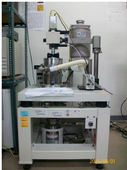
圖 3-1 左圖為本實驗用的 SPA-300HV；右圖為 SPA-300HV 之架構
