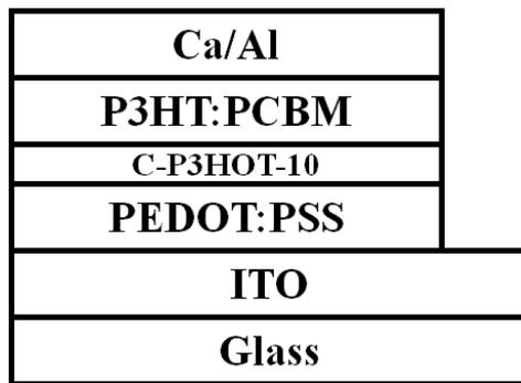
圖 4-8. 有機太陽能電池之元件結構
