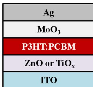
圖 1-6. 混摻異質界面元件之反結構(以三氧化鉬取代 PEDOT:PSS)
