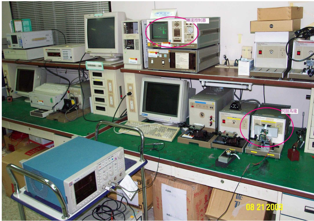
圖 A.1: 下線反電動勢量測法
