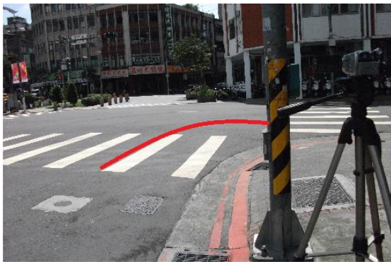
圖 6.5 衝突時車速量測方式
