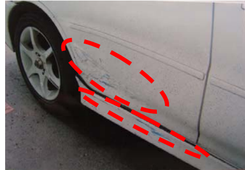
資料照片翻拍 A 車右後車門新刮擦痕 (案例 62C02)
