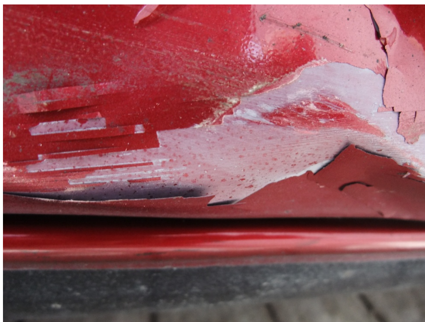
照片 5.7.2-e 車身有灰塵之 A 車左側車門受損情況 (實驗 3A02)
