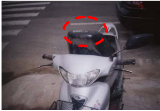
資料照片翻拍 B 車車墊新刮地痕 (案例 62B14)
