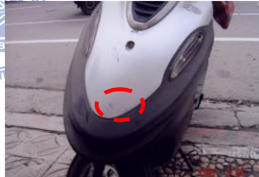
資料照片翻拍 B 車前車頭新刮擦痕 ( 案例 980911 )
