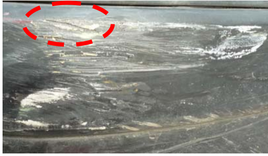
現場採證 A 車右後車尾刮擦痕重疊 ( 案例 61C04 )
