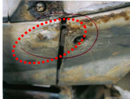
資料照片翻拍 B 車左側車身新刮擦痕 (案例 62C23)
