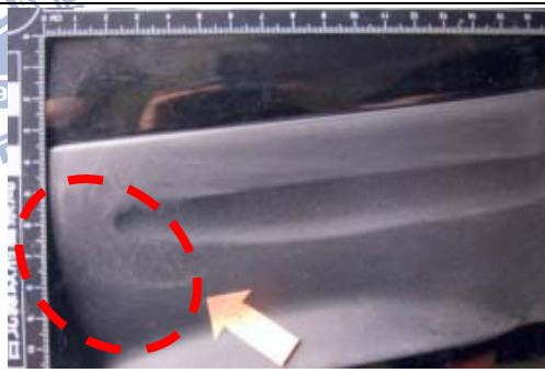
資料照片翻拍 A 車左前車頭新刮擦痕 ( 案例 62C10 )
