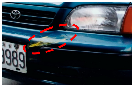
資料照片翻拍 A 車車頭新刮擦痕 ( 案例 62A29 )
