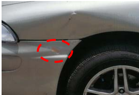
資料照片翻拍 A 車左前車頭新刮擦痕 (案例 62C05)
