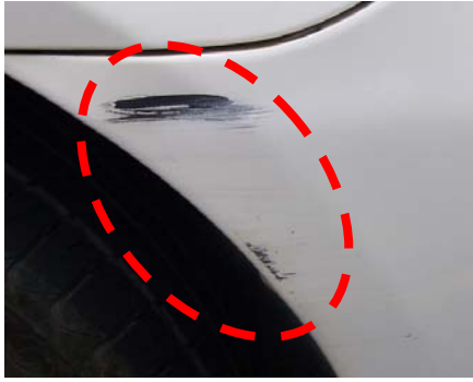
現場採證 B 車右前車頭舊刮擦痕 ( 案例 61A03 )
