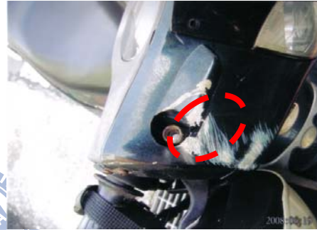
資料照片翻拍 A 車右前車頭舊刮擦痕 ( 案例 2B22 )
