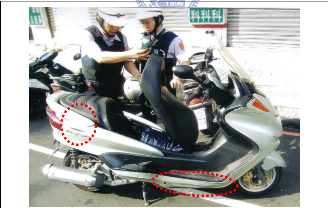
照片 4.3.3-22n 資料照片翻拍 B 車右側車身新刮擦痕 (案例 2B22)
