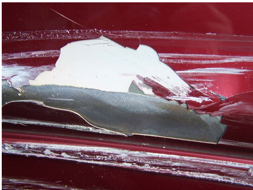
照片 5.7.2-m 深刮擦痕之 A 車左後車門受損情況 (實驗 3A01)
