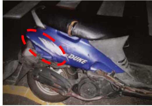
資料照片翻拍 A 車右側車身新刮地痕 (案例 62C15)
