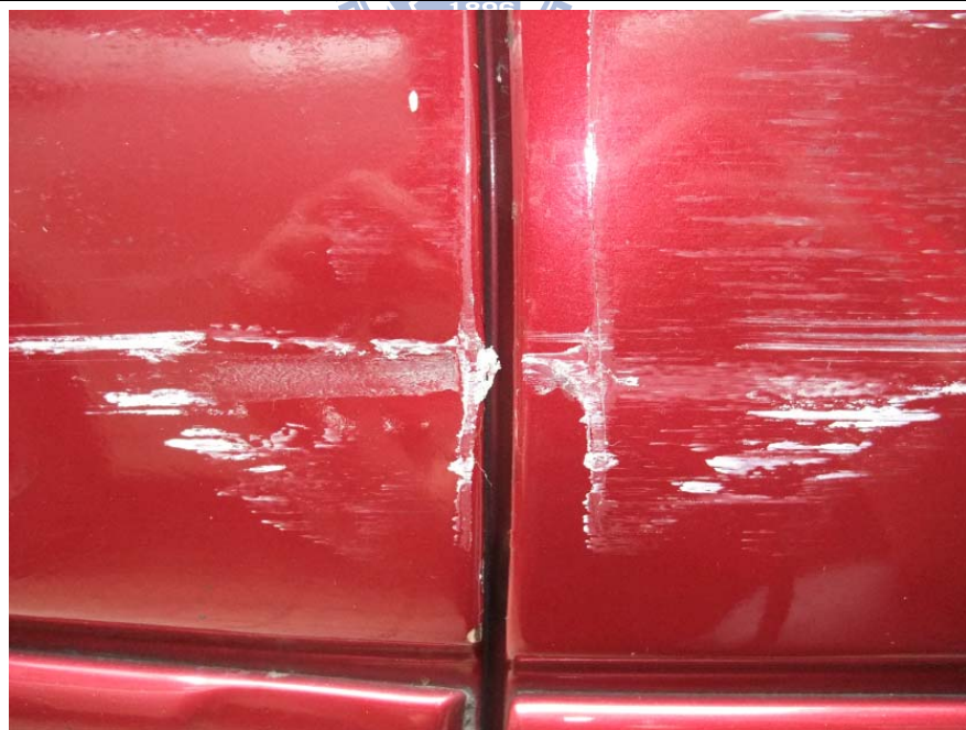
照片 5.7.2-t 淺刮擦痕之 A 車右側車門受損情況 (實驗 3A03)
