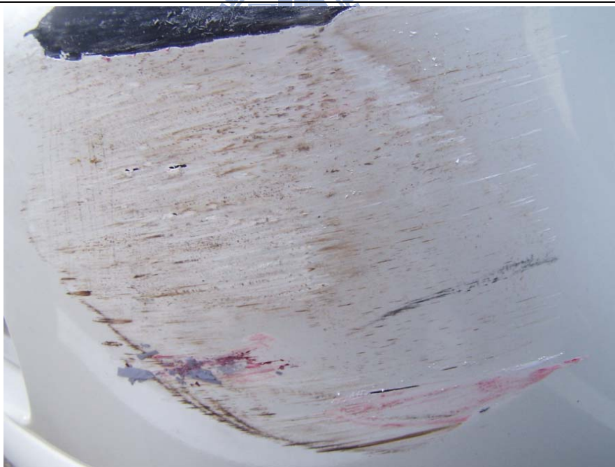
照片 5.7.2-d 車身乾淨之 B 車左前車頭受損情況 (實驗 3A02)
