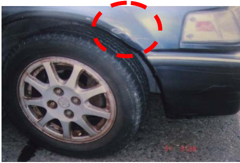
資料照片翻拍 B 車右前車身新刮擦痕 (案例 62C01)
