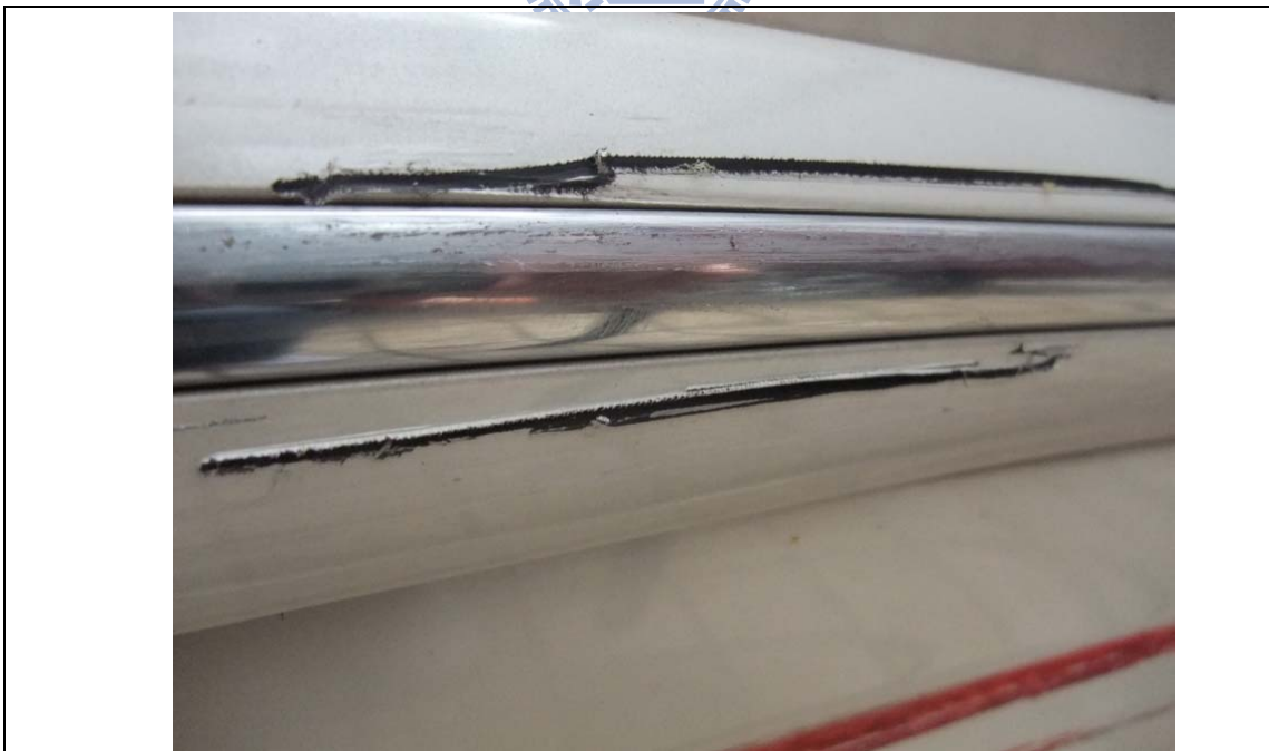
照片 5.7.2-v 洗車後之 B 車左後車門受損情況 (實驗 3A04)
