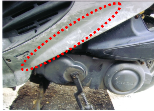
資料照片翻拍 A 車左側車身舊刮擦痕 (案例 2B22)
