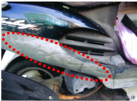
資料照片翻拍 A 車右側車身舊刮擦痕 (案例 2B22)
