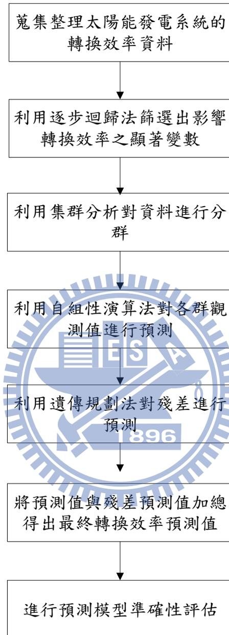
圖 3.1 建構三階段轉換效率預測模型之流程圖
