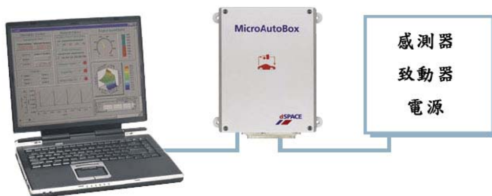
圖3.2：MicroAutoBox與其他裝置連接示意圖
