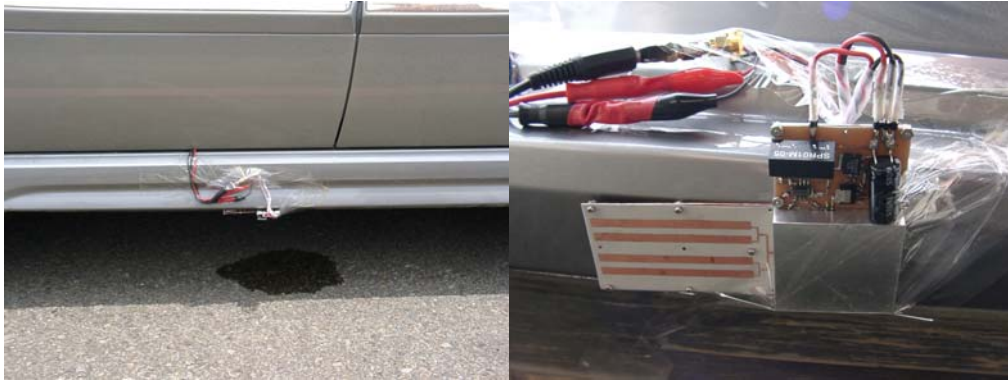
圖 4.1：測速雷達裝置在車輛底盤
