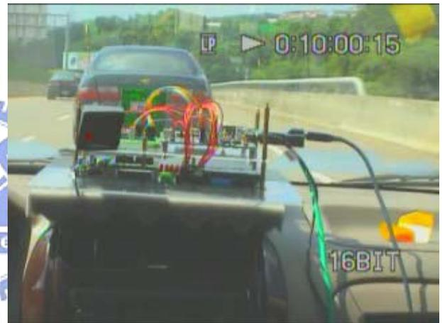
圖 4-35 系統發出碰撞警示燈
