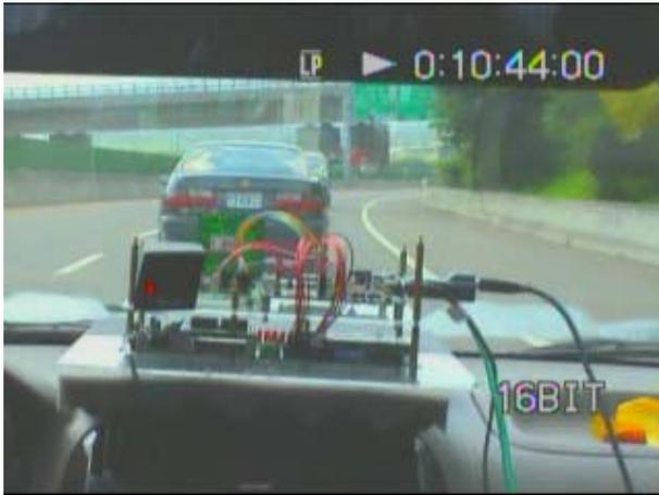
圖 4-44 前車接近，系統警示
