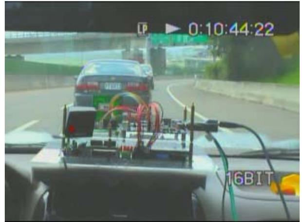
圖 4-45 前車接近，系統警示
