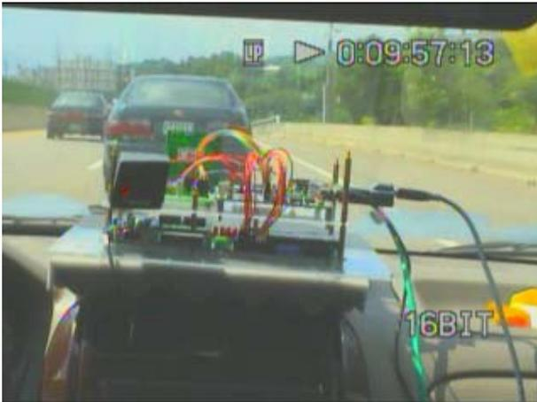
圖 4-32 系統發出碰撞警示燈
