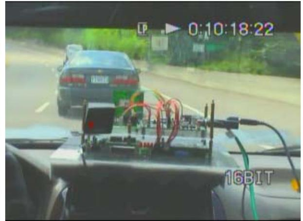
圖 4-39 前車接近，系統警示
