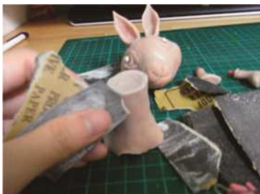
圖 30 製作過程 - 研磨表面
