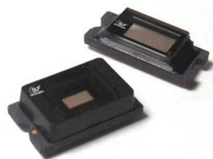
圖 2.3 · DLP Pico 晶片組，左為第一代，解析度 480×320；右為第二代，解析度 854×480，資料來源：TI
