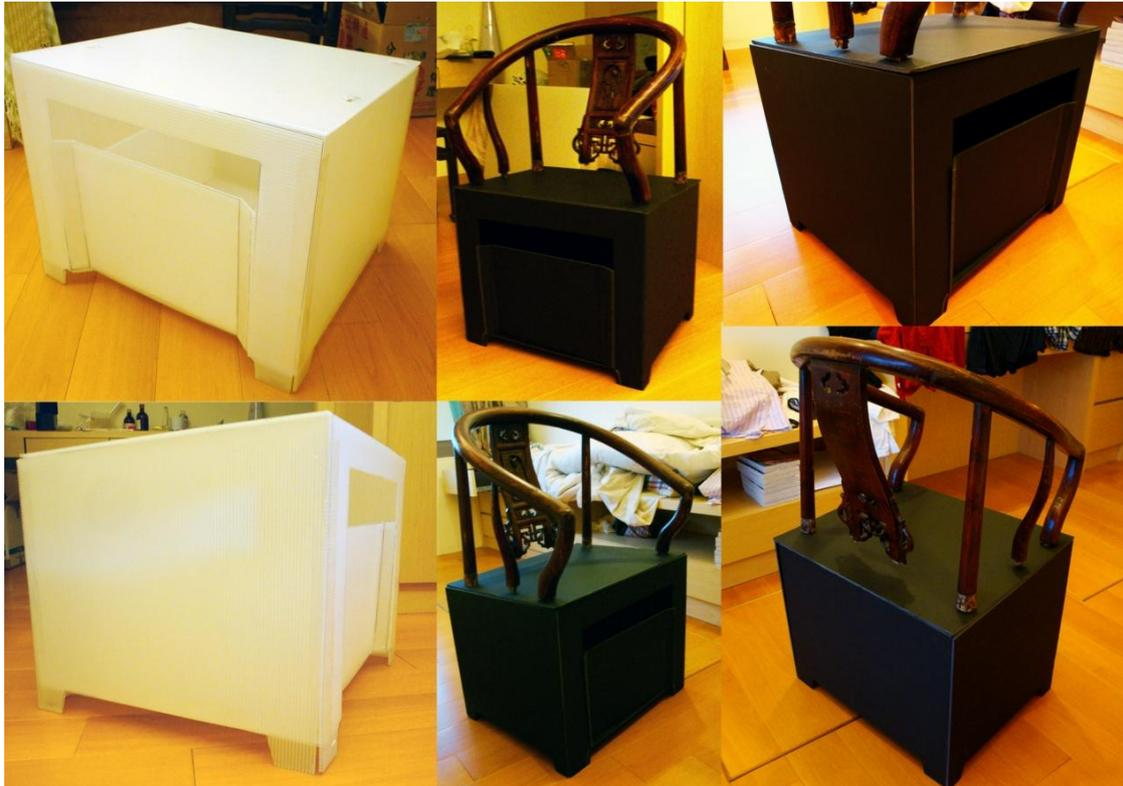
圖 5.2.2 草模製作與細節比例確定
