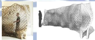
圖 41 蜂巢狀網格牆體使光線與空氣可以自由通過並提供視景。
