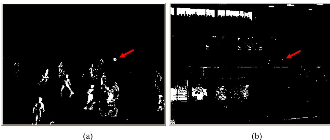
圖 3-3 修補排球球體前景之過程 (a) 待修補影像，(b) 灰階影像相減結果為 0 且原灰階值大於 200。
