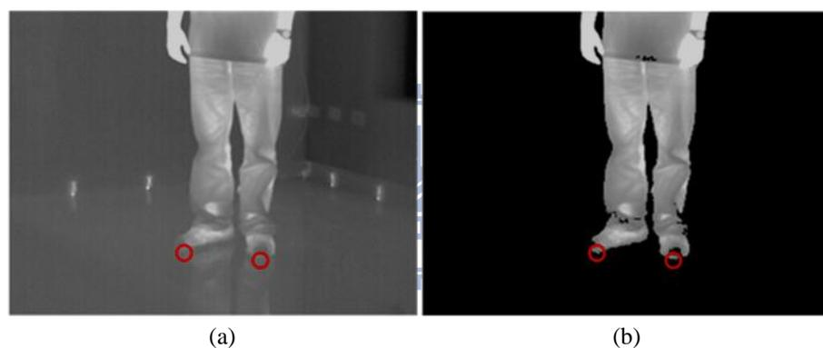
圖 3-4 利用區域最低點計算目標物立足點。(a)原始影像，(b)目標物前景區塊。
