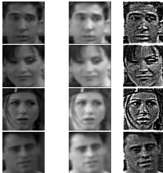
圖 3-9：兩種前處理所得影像（左：原人臉影像、中：Luminance Normalization + Gaussian Low-pass 結果、右：LoG 結果）
