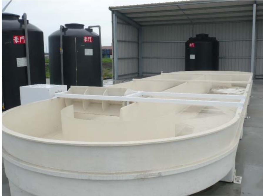
圖 3.1、渠道池藻類培養系統
