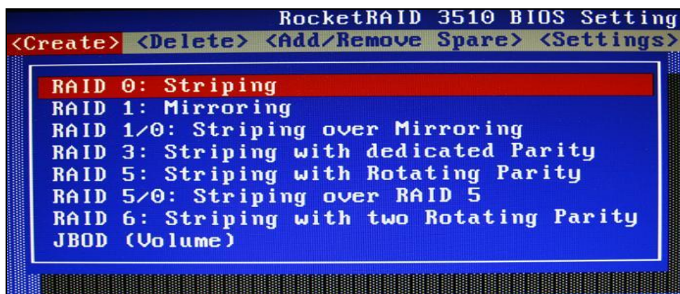
圖 3.4.1-1 RocketRAID 3510 SATA Controller 設定畫面
