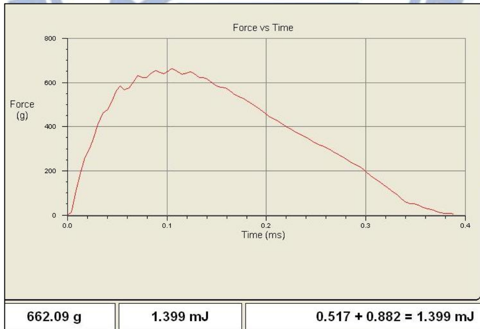
圖 4.11 SAC105& SAC305 高速推球過程之剪力與破斷反應時間示意圖
