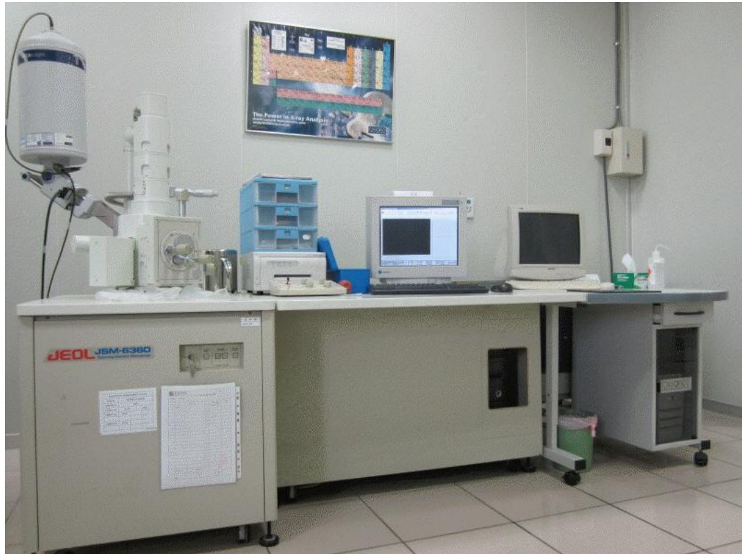
圖 3.4 掃描式電子顯微鏡( SEM, JSM-6360 )附能量分佈光譜儀
