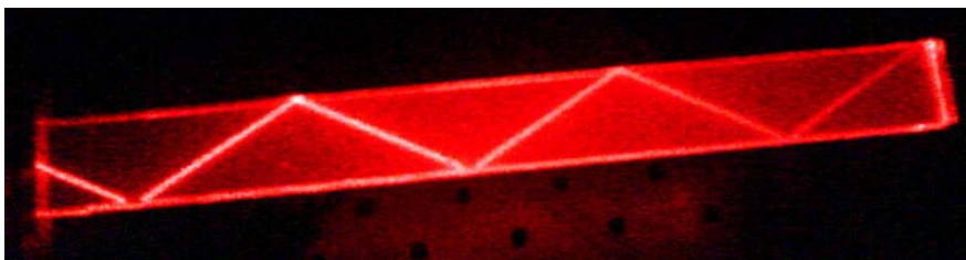
圖 2-10 光束在壓克力中的全內反射現象[3]
