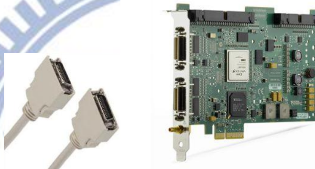
圖 3-2(b)Camera Link 影像擷取卡與接頭排線
