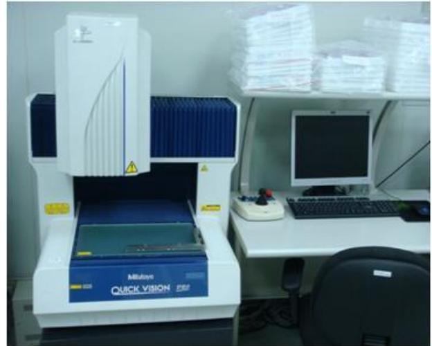
圖3-10 塗層滲透深度量測設備
