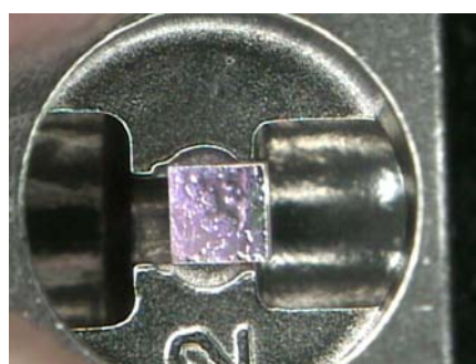
圖 3-23 0°Filter 髒污、刮傷
