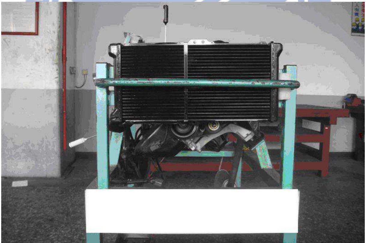
【圖 4-8】銅製水箱安裝圖
