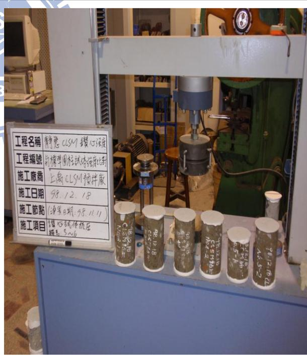
鑽心試體抗壓強度試驗(CNS 1238)
