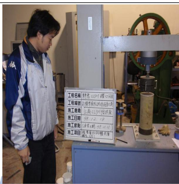
圓柱試體抗壓強度試驗(ASTM D4832-02)
