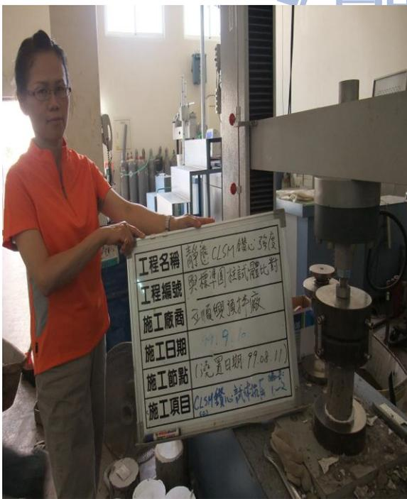
CLSM 鑽心試體抗壓試驗
