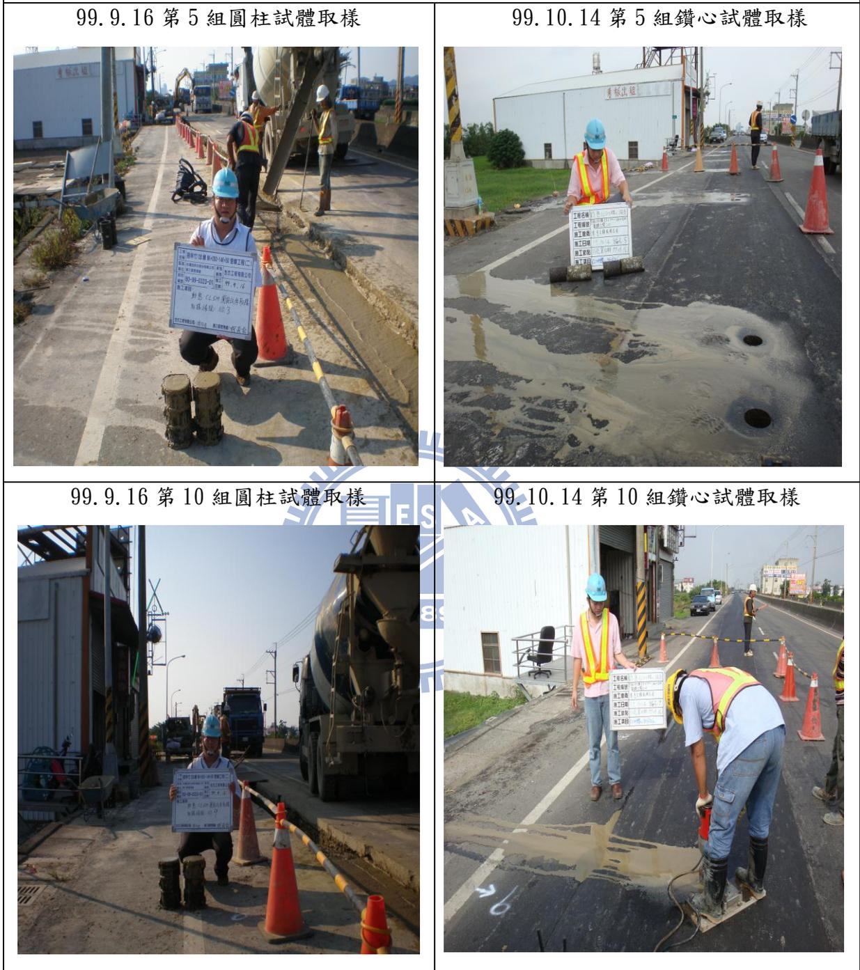
圖 4-7 芎林竹 120 線管線工程(二)CLSM 圓柱及鑽心試體現場取樣
