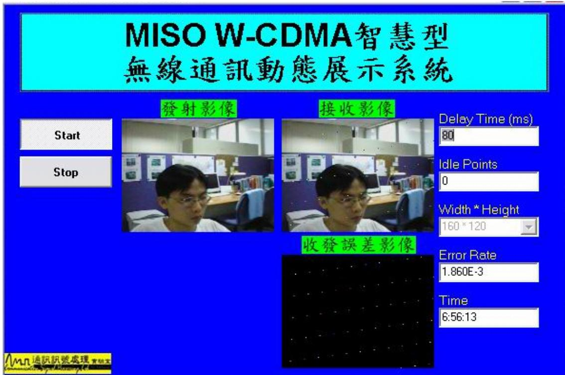
圖 4.30 使用八根傳送天線及波束形成器之動態影像傳輸圖，其BER為  $1.86 \times 10^{-3}$
