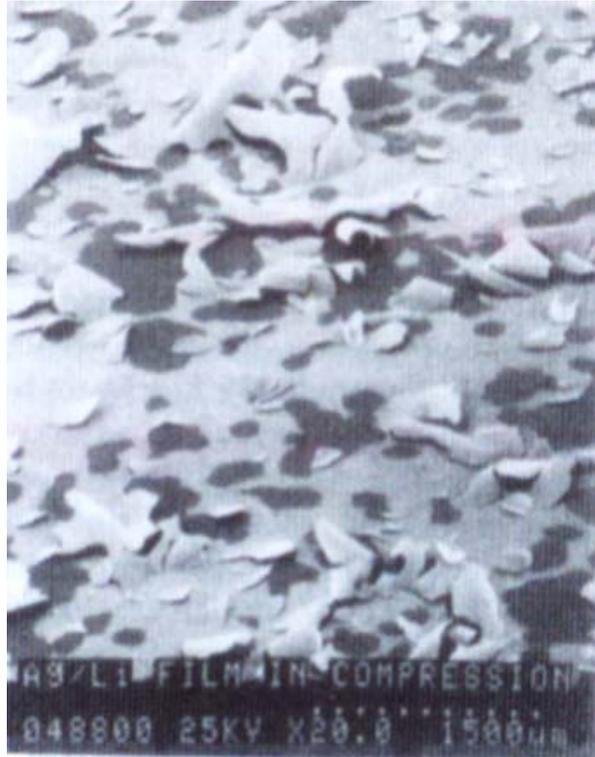
圖1-1 太高的壓縮式薄膜應力導致Ag/Li薄膜剝離[19]。
