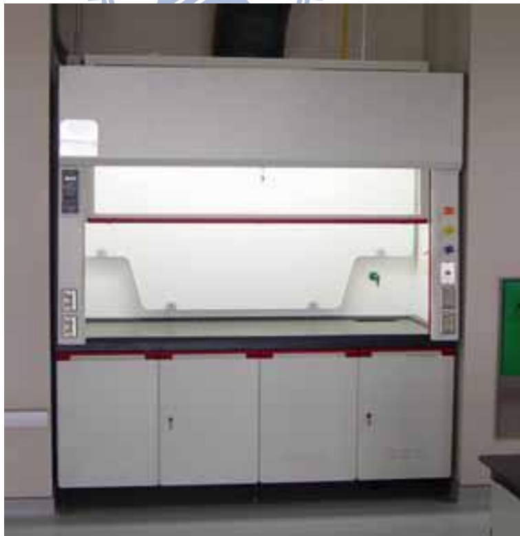
圖1. 流場可視化實驗中觀察的排氣櫃本體 [6]。
