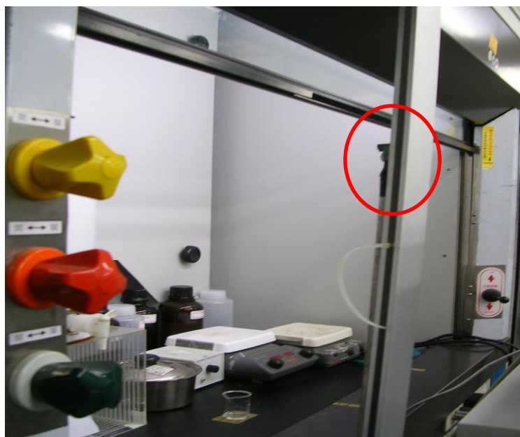
圖 12. 即時監測器的採樣口架設實體圖。
