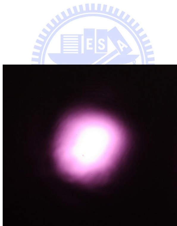
圖 3-12 鎖模狀態最佳化時的光斑
