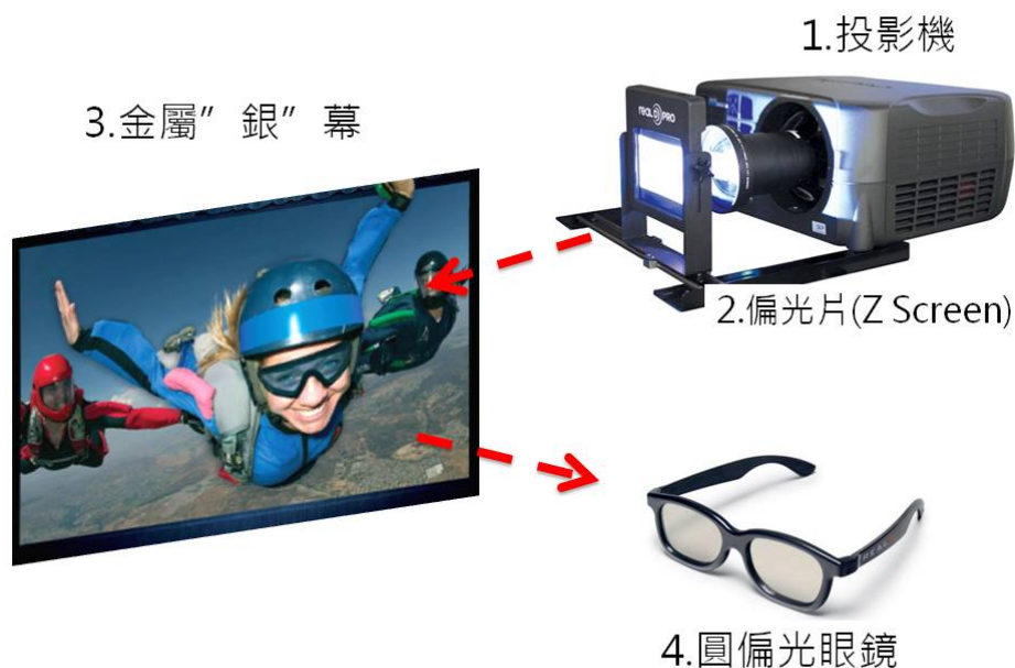
圖 3-12 RealD 眼鏡式極化多功法(圓偏振)立體顯示技術示意圖
