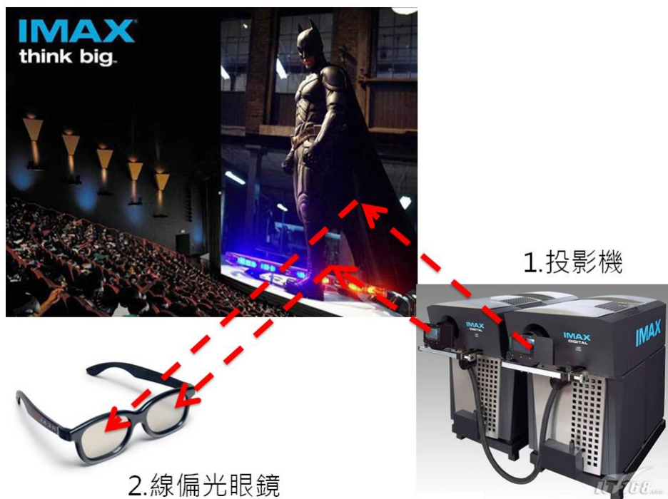
圖 3-13 IMAX 眼鏡式極化多功(線偏振)立體顯示技術示意圖
