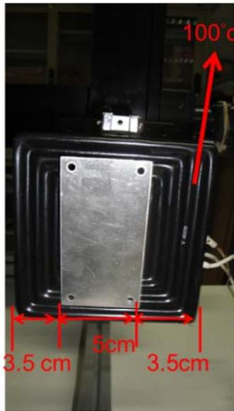
圖 4.14 熱陶瓷加熱板及金屬片實照圖
