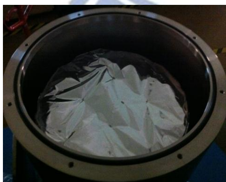
圖 四十八. 腔體表面包覆 30 層超絕緣層
