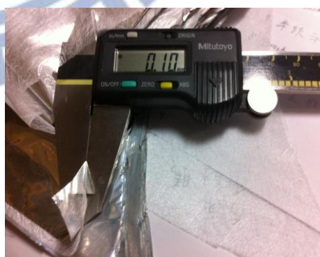
圖 四十九. 每層超絕緣層厚度約為 0.1 mm
