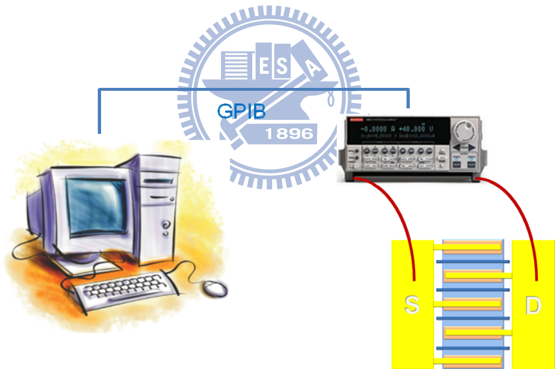
圖 3.1 直流電性量測示意圖。
