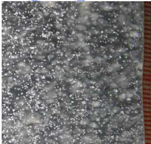
圖 5.13 含水楊酸原水進流入污泥毯設備所生成之膠羽外觀
