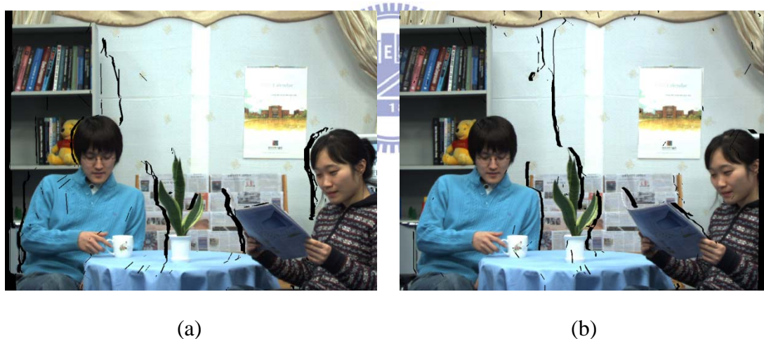
圖 5-7 MPEG 測試影像 “Newspaper”由鄰近兩個攝影機視點位置正向投影映射後的結果，其中(a)由視點 04 投影映射至視點 05 的目標影像結果以及(b)由視點 06 投影映射至視點 05 的目標影像結果
