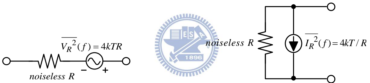
圖 2-3(a) 電壓源的電阻熱雜訊模型
