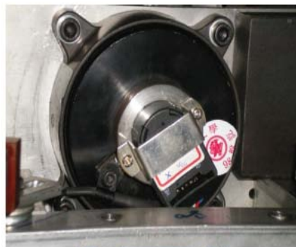
(b) 軸編碼器加裝於伺服煞車器
