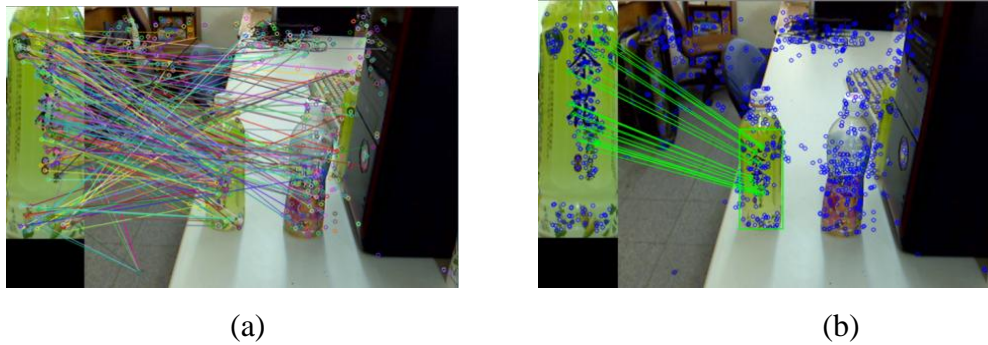
圖 2.6 (a)SURF 特徵點比對(b)RANSAC 估側平面轉換矩陣
