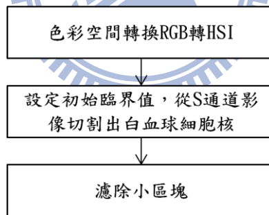
圖 3.17 色彩空間轉換及面積過濾流程圖。
