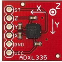
圖 2-14 ADXL335 三軸加速度計模組外觀
