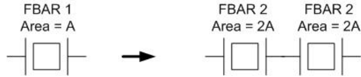
圖 (6.1) 2 顆串接 FBAR 與欲等效 FBAR 的關係 (厚度相同)
