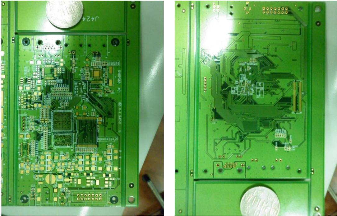
圖3- 16 洗板後的裸板正面及反面
