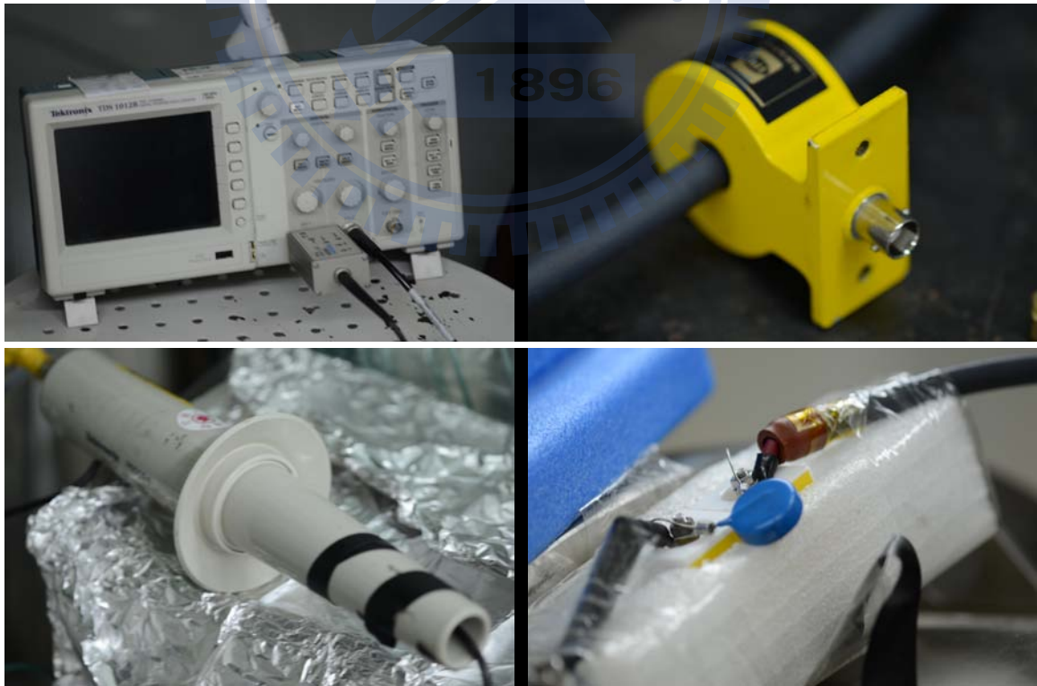
圖 2.12 高壓探棒、電流感測器與耐高壓電容
