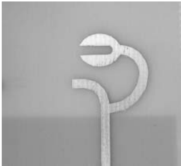
圖 2-28 雙頻整型天線設計(二) 之實作天線電路
