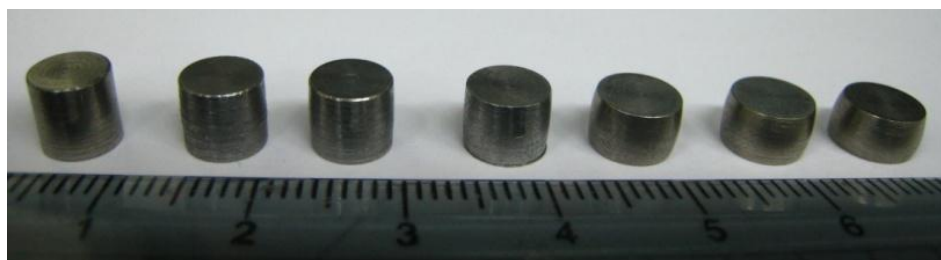
圖 16 極低碳鋼 d_0=6 、 h_0=6 試棒以 1300~2500 公斤重壓縮試驗結果
