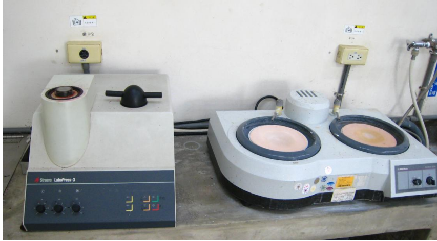
圖 21 熱鑲埋機及拋光機
