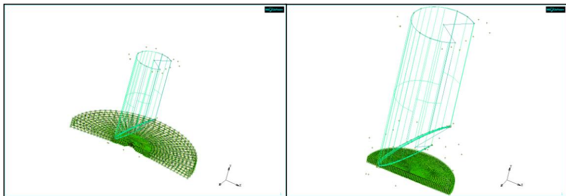
圖 60 67g(左)、38g(右)封片穿刺模擬網格劃分圖
