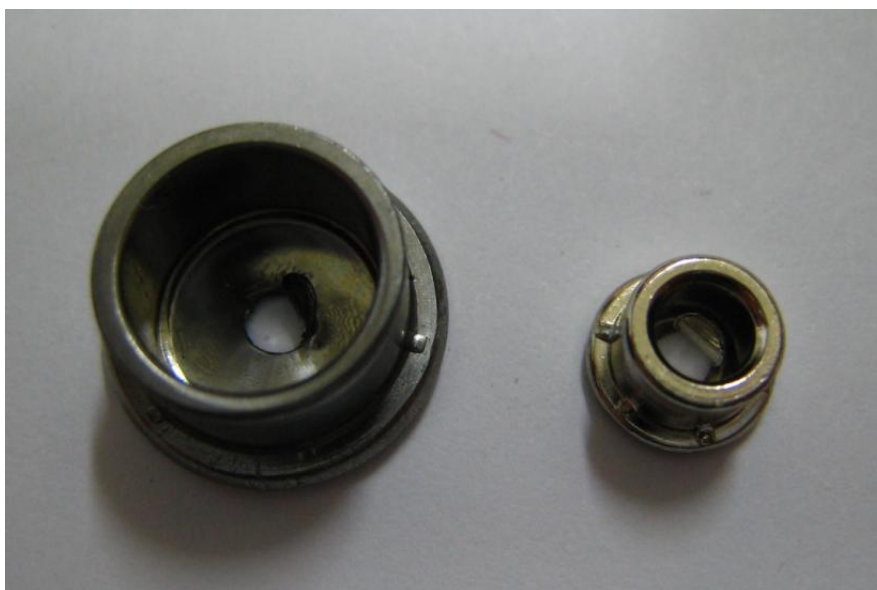
圖 55 67g CO 2 高壓鋼瓶封片穿刺力實驗後成品
