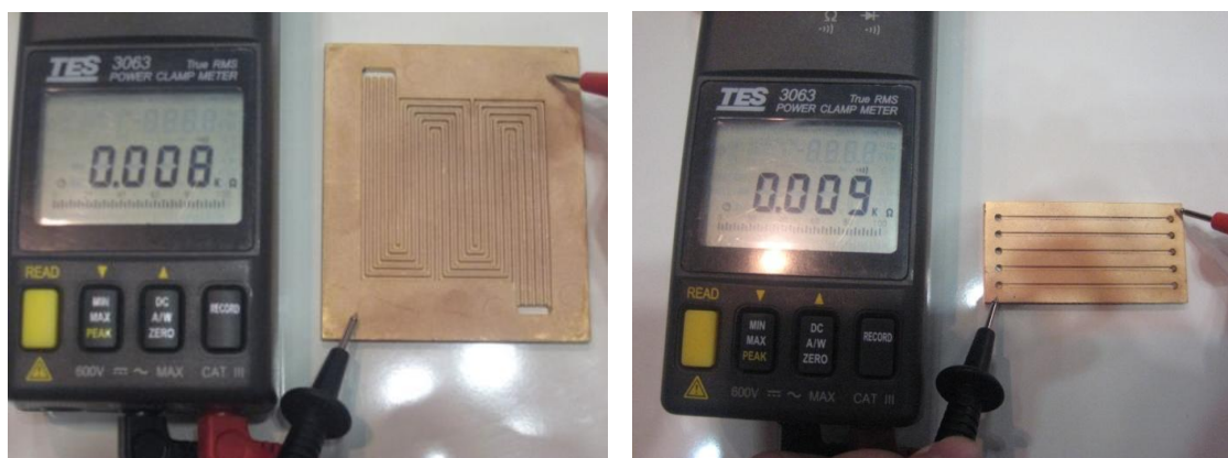
圖 4-3 鍍膜後雙極板接觸電阻量測
