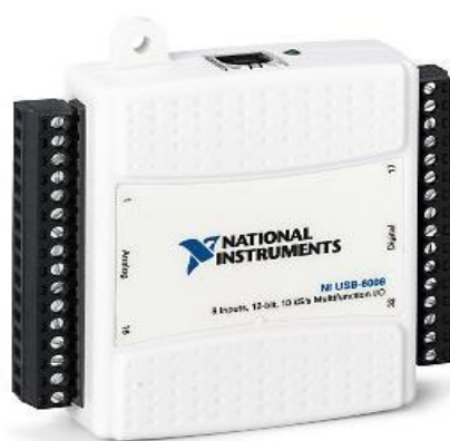
圖 3-12 資料擷取設備 NI USB-6008[65]
